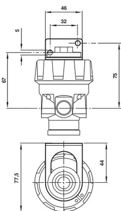
Монтажная панель с диаметром отверстия: 32 мм
